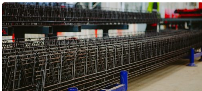
Raidisseurs d'armatures prêts pour la fabrication des prémurs.
