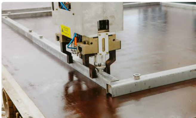
Robot de coffrage : mise en place automatisée des coffrages sur table, usine PCS.
